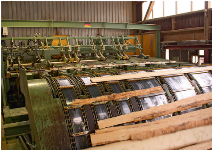
Vereinzelung und Zuführung der Seitenware zum Manipulationstisch vor dem Optimes beim Sägewerk Bulthaup
