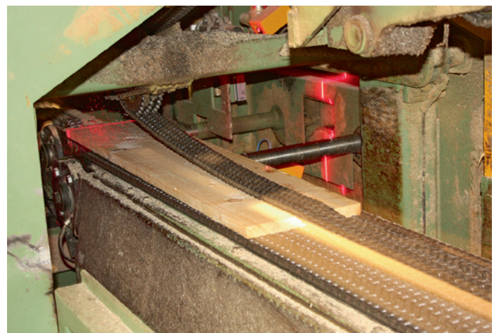
Vermessung der Brettware: Durch das vorherige Kappen wird eine höhere Ausbeute erzielt
