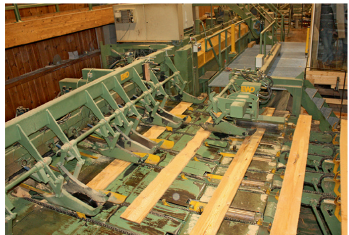
Manipulationsbereich im Quertransport mit Ausschleusklappe und Kappung bei Holtmeyer
