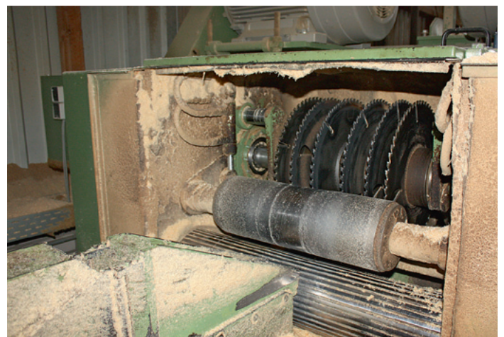
Der Besäumer BKO im Sägewerk Bulthaup verfügt über zwei Trennflansche (vier verstellbare Sägeblätter)
