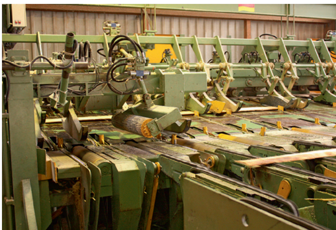
Schwartenanläufe werden noch gekappt, dann geht es im Quertransport durch die Kreissägen zur Vermessung
